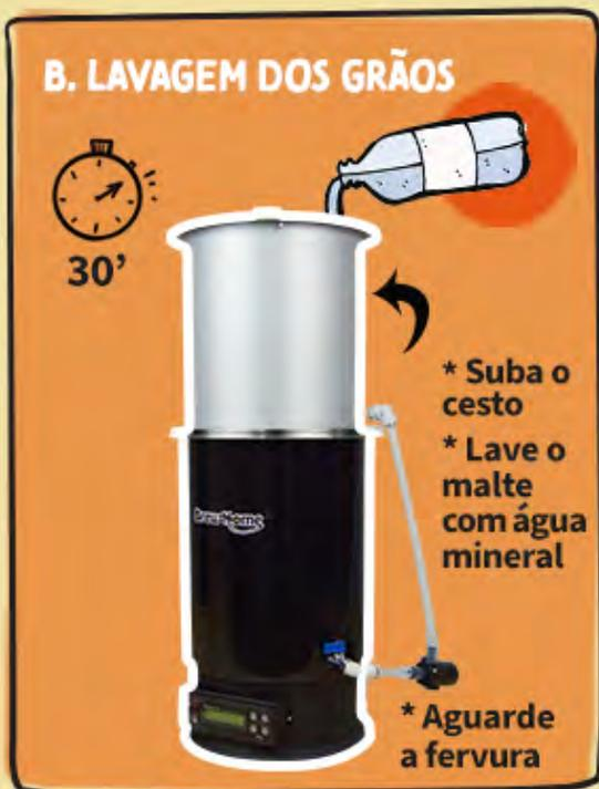
1.8 - Ligue o programa para avançar para a FERVURA. Mantenha o cesto de grãos sobre a panela ou use a tampa, desta forma a temperatura sobe mais rapidamente. NUNCA FAÇA A FERVURA COM TAMPA.
